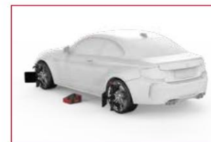
Perfecto para canaletas de reparación de automóviles. Se pueden colocar dos unidades de medición en el suelo para realizar mediciones de alineación de las cuatro ruedas.
