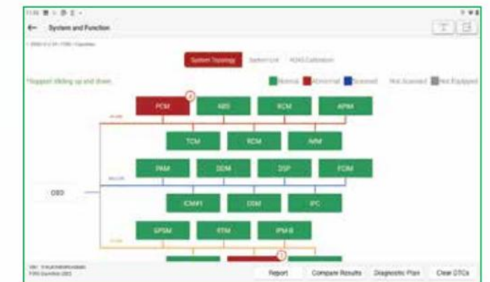
Gráfico topológico para la localización rápida de fallas
